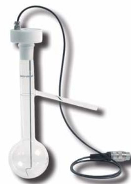
Trockenpunktsensor im Destillationskolben
