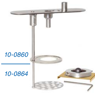
Modifiziertes Haltegestell mit Zubehör ähnlich der Wilhelmi Methode (10-0860 & 10-0864)
