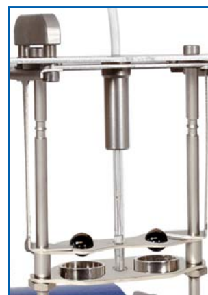
solution de centrage & dépose mécanique de Petrotest® (10-0840) (compris dans la livraison standard)
